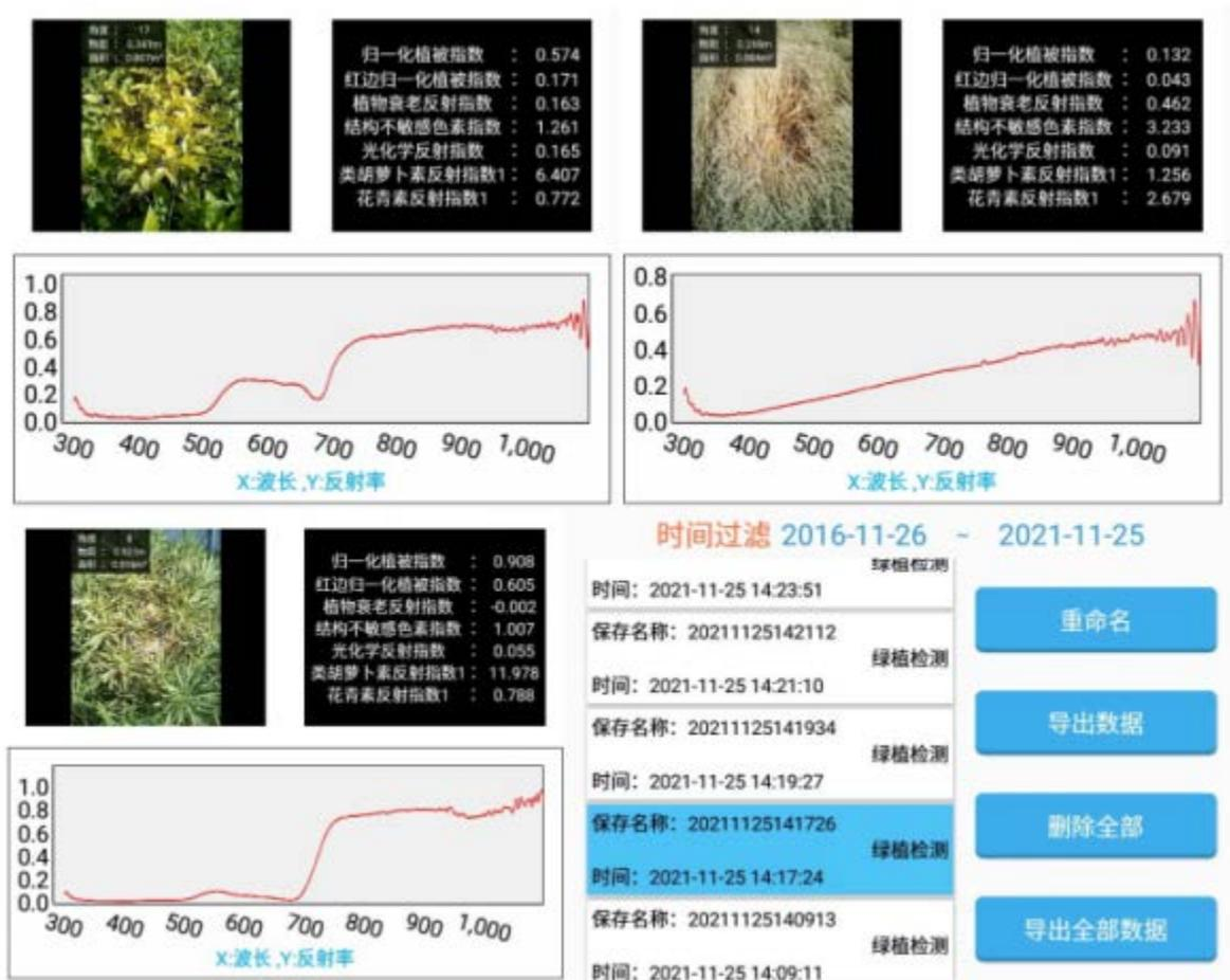
图 7 ATP9100 地物光谱仪植被指数检测结果
