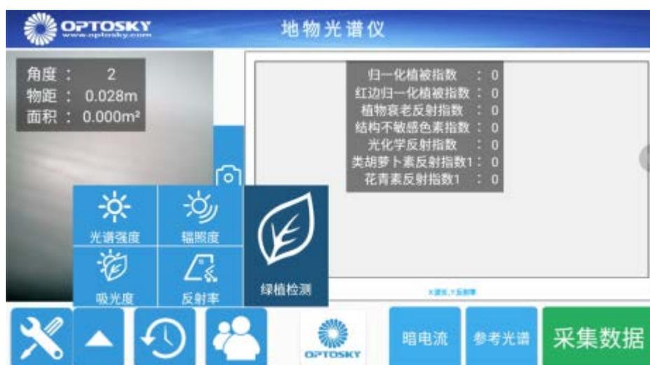
图 5 ATP9100 地物光谱仪植被指数功能键界面
